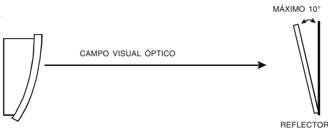
Figura 2b: Instrucciones para el montaje del reflector
